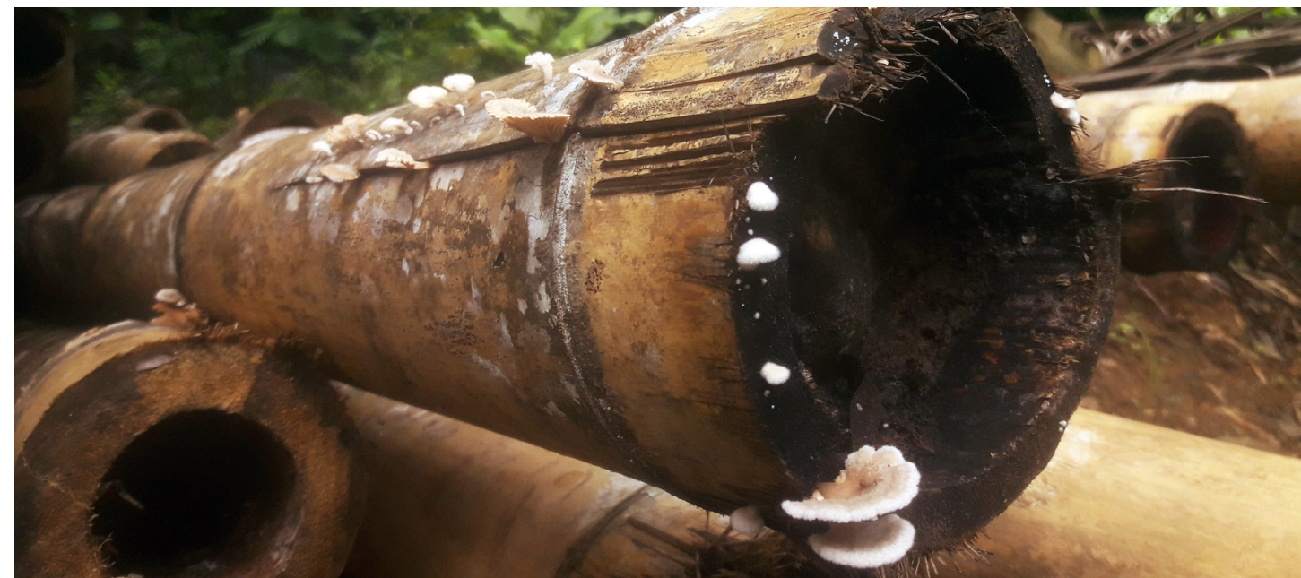
27. Hongos en cañas de bambú sin usar para construir. Nota. Un adecuado manejo del material asegura su durabilidad, pero en caso de que no sea así, este se reincorporará al ciclo del ecosistema. De Alejandro Alcázar, 2022, Archivo AAF. CC BY-NC 4.0
